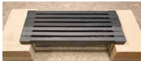
棒口ストル。一枚の板のようなものではなく、隙間が開くように棒状のものが組んである
